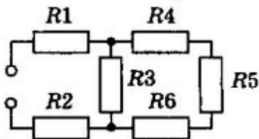
6. Сопротивление всех резисторов одинаковы и равны 2 Ом. Найти распределение токов и напряжений, если ЭДС источника 60 В, внутреннее сопротивление 1 Ом
