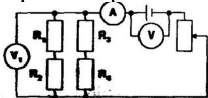
5. Определить токи в каждом из сопротивлений, если ЭДС источника 10 В. Внутреннее сопротивление 1 Ом. R<sub>1</sub>=3,5 Ом, R<sub>4</sub>=2 Ом, R<sub>2</sub>=4 Ом, R<sub>6</sub>=4 Ом, R<sub>3</sub>=20 Ом, R<sub>5</sub>=1,5 Ом.
